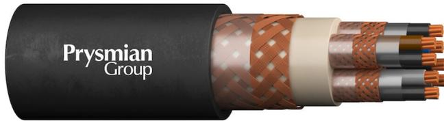
Für die feste Installation auf Schiffen an allen Orten und auf offenen Decks. Es gelten die Definitionen für die Installation nach BV 3400. Die Kabel sind vom Bundesamt für Ausrüstung, Informationstechnik und Nutzung der Bundeswehr (BAAINBw) zertifiziert.
